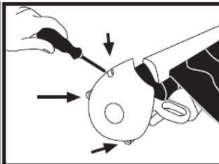
19. Infine, monta la barra laterale avvitando le tre viti che stanno nello scudo laterale.
