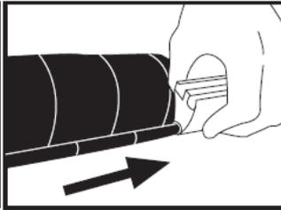
14. Una volta che il telo e' avvolto completamente fai scivolare l'estremita' nella barra della mantovana.
